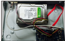
4 Συνδέστε καλώδια τροφοδοσίας και δεδομένων.
