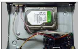
3 Γυρίστε το καταγραφικό ανάποδα και τοποθετείστε το δίσκο.
