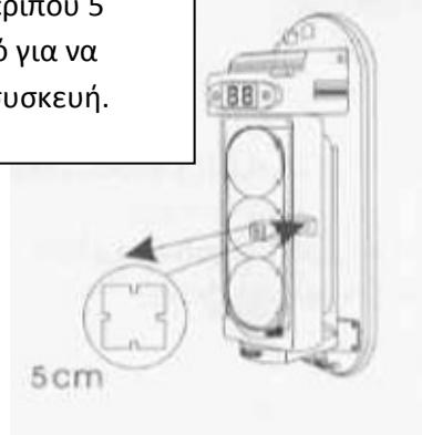
Ρυθμίστε την κλίση στο οριζόντιο και κατακόρυφο επίπεδο ώστε να έχετε την μέγιστη δυνατή ένδειξη σήματος.
